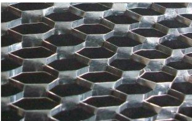
Eingebracht in Behältern, Kanistern, Tanks und anderen Lagerstätten, bei denen sich explosive Gemische bilden können, werden mit **eXess - Produkten** die verheerenden Auswirkungen einer Explosion verhindert.
