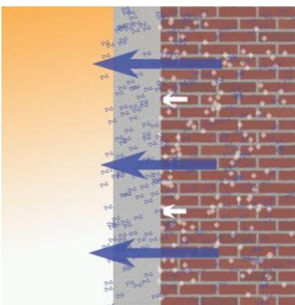
**benqusan** Feuchtmauerputze machen sich die physikalischen Grundlagen der Feuchtebewegung, Diffusion, Oberflächenvergrößerung und Verdunstung zunutze. Sie bekämpfen gleichermaßen Schäden durch kapillare Feuchtigkeit, hygrokopische Feuchtigkeit und Kondensation.
