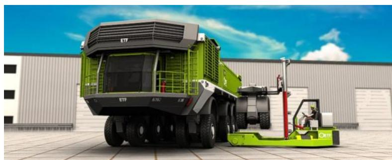
So z.B. dauert der Tausch einer Batterie oder eines Radsatzes ca. 15 Minuten. Danach kann das Fahrzeug wieder in den Produktionsprozess eingegliedert werden. Die Reparatur der defekten Module bzw. das laden der Batterien erfolgt in der ETF-Basis und steht danach einem anderen Fahrzeug zur Verfügung.
