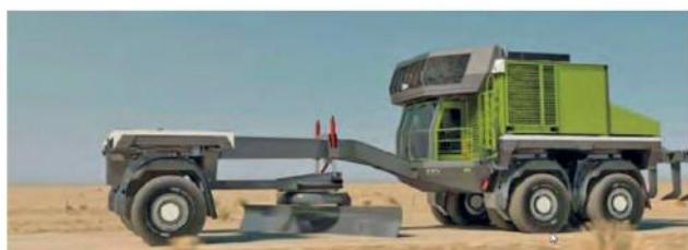
ETF - das sind nicht nur Fahrzeuge, sondern ein ganzes System, welches unterschiedliche Fahrzeuge, Geräte und mobile Bagger umfasst, die zum Grossteil aus gleichen Modulen bestehen. Ebenfalls beinhaltet dieses System die Wartung und Reparatur vor Ort. Durch den Tausch von kompletten Modulen oder leeren Batterien kann eine Auslastung der einzelnen
