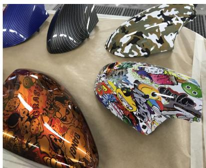
Der Wassertransferdruck ist ein Oberflächenbeschichtungsverfahren, bei dem das Objekt teilweise oder vollflächig mit einem Dekor überzogen wird. Das funktioniert mit nahezu allen Oberflächen in fast allen zwei- und dreidimensionalen Formen, selbst wenn die Objekte keine geraden Kanten und Flächen aufweisen.
