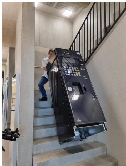
Der Treppensteiger „**EASYLIFT®**“ hat eine ausgezeichnete **Hebeleistung von 500kg** und besteht aus einer äusserst stabilen Aluminium-Konstruktion. Dadurch wird das Eigengewicht minimiert. Last berührende Holmen sind mit abriebfestem
