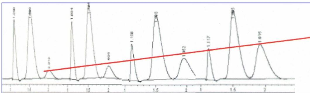
Die Grafik (Gaschromatograph) zeigt, dass man in einem ersten Durchlauf das Kältemittel R134a trennen kann. In einem weiteren Durchlauf werden dann die Kältemittel R125 und R32 getrennt.
