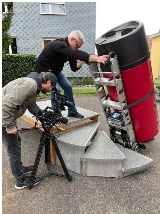
Kunststoff belegt. Somit können die Lasten unverpackt mit dem Treppensteiger **EASYLIFT®** transportiert werden. Die eigentliche „Arbeit des Steigens“ übernimmt ein Akkubetriebenes System.
