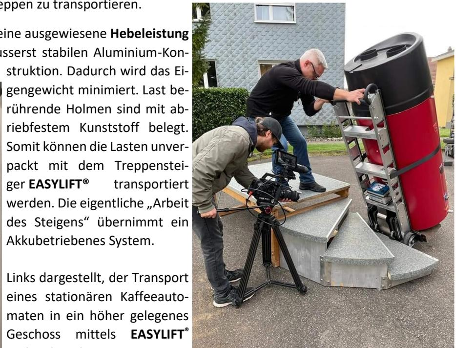
Links dargestellt, der Transport eines stationären Kaffeeautomaten in ein höher gelegenes Geschoss mittels **EASYLIFT®** und rechts, der Transport eines Kessels über eine gewedelte Treppe.
