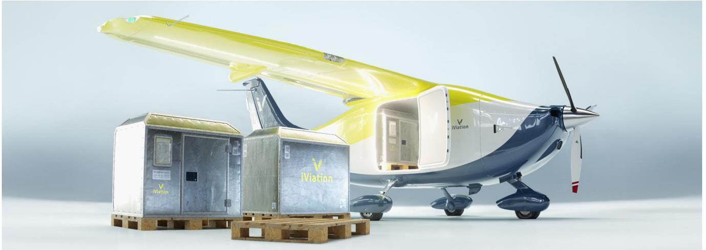
Autonom fliegen bedeutet, im Gegensatz zur Drohne, die vom Boden aus gesteuert werden, dass vor dem Start der Zielort eingegeben wird und das Flugzeug selbstständig, ohne menschliche Eingriffe, unter Nutzung von Künstlicher Intelligenz (KI), GPS-Navigation und Vorgaben durch staatliche Stellen (z.B. Flugsicherung), startet, zum Zielflughafen fliegt und dort selbstständig landet.
