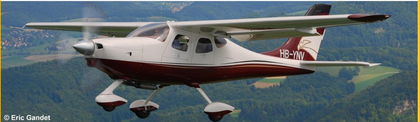
Die **TR230 Traveler** ist ein einmotoriges, geräumiges 4-sitziges Flugzeug. Die Konstruktion besteht aus Kohlefaser (CFK) und die 3. Tür erleichtert den Einstieg in die hintere Sitzreihe. Der Erstflug fand am 04.12.2015 statt. Zwischenzeitlich wurden zahlreiche Testflüge absolviert.
