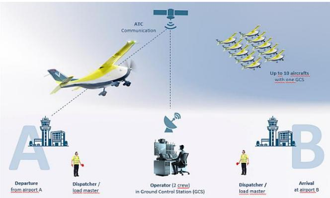
über eine Bodenstation (GCS), die den Funkverkehr mit der Flugsicherung übernimmt und damit in der Lage ist, entsprechende Änderungen im Flugplan vorzunehmen. Autonom bedeutet auch, dass das Flugzeug selbstständig auf Probleme und Notfälle reagiert. Die Bodenstation (Ground Control Station – GCS) kann perspektivisch bis zu 10 Flugzeuge parallel kontrollieren.
