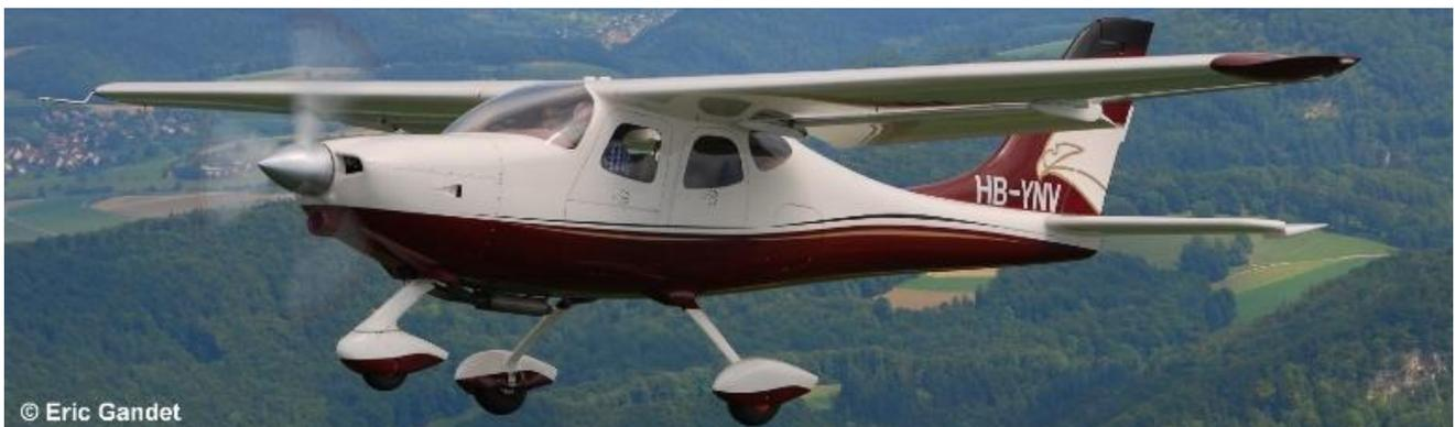
Die **TR230** ist ein einmotoriges, geräumiges 4-sitziges Flugzeug. Die Konstruktion besteht aus Kohlefaser (CFK) und die 3. Tür erleichtert den Einstieg in die hintere Sitzreihe.
